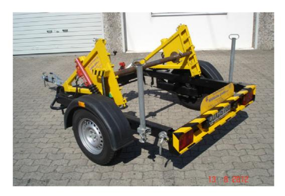
Zum Einbringer der Trommel wird die Hecktraverse (gelb/schwarz gestreift) geöffnet.
