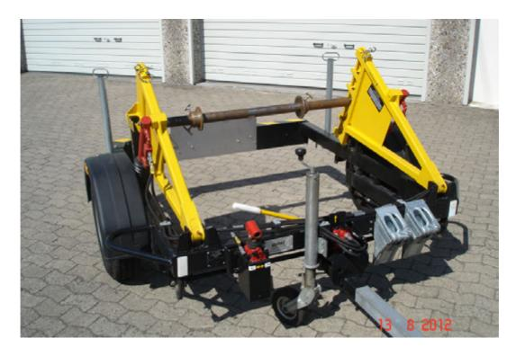
Mit der Hydraulikpumpe vorne links werden die beiden Stemmbalken hoch/runter bewegt.
