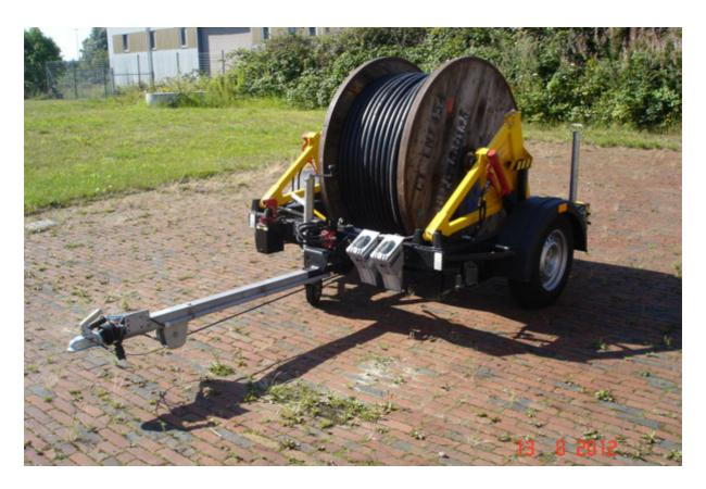
Anhänger mit großer Kabeltrommel (1,4m Durchmesser) bespult mit Leitung H07RNF- 4\_G\_ 70mm²
