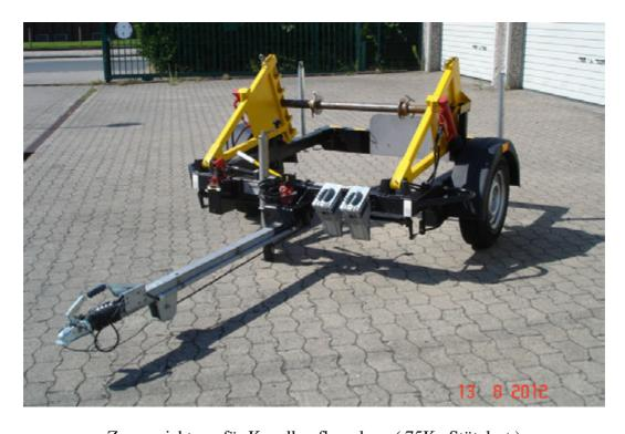
Zugvorrichtung für Kugelkopfkupplung (75Kg Stützlast)
