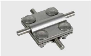
Kreuzstücke mit Zwischenplatte Art.-Nr. 318 229 Werkstoff Klemme: NIRO (V4A) Klemmbereich / Seilbereich: Rd / Rd: 7-10 mm; Rd / Fl: 7-10 / 30-40 mm; Fl / Fl: 30-40 mm
