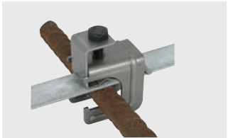
Druckbügelklemme Art.-Nr. 308 031 Werkstoff: St/blank Klemmbereich Rd 6-20/Rd 6-10 mm; Rd 6-20/ Fl 30 mm; Fl 30/ Fl 30 mm
