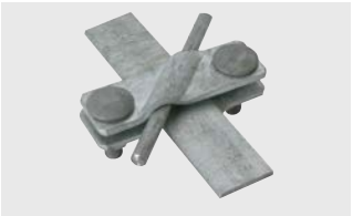
SV-Klemme Art.-Nr. 308 220 Werkstoff: St/tZn Klemmbereich Rd / Fl: Rd 7-10/ Fl 30 mm
