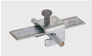
Verbindungsklemme Art.-Nr. 308 026 Werkstoff: St/tZn Klemmbereich Rd / Fl: (+) 6-10 / 30 mm
