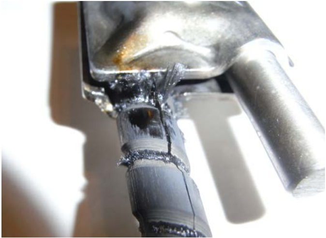
Prüflinge nach Belastung mit 20 kA (10/350 µs Blitzstrombelastung)
