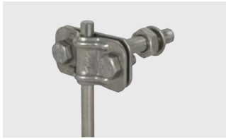
Anschlussklemme mit Gewindebolzen Art.-Nr. 478 129 Werkstoff Klemme: St/tZn Klemmbereich: Rd / Fl 7-10 / 30-40 mm Zum Anschließen an Erdungsfestpunkt
